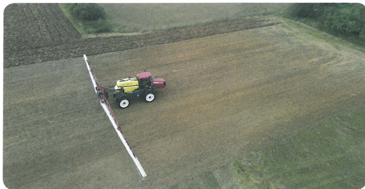
Jako první se představil samojízdný postřikovač Hardi Alpha evo. Konkrétní model byl vybaven nádrží s objemem 4200 l a rameny TwinForce s pracovním záběrem 40 m
