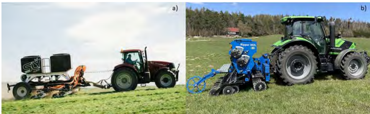
a) Pneumatický secí stroj Agrisem SLY BOSS může být vybaven až 4 komorami pro setí (foto: Martin Matěj)
