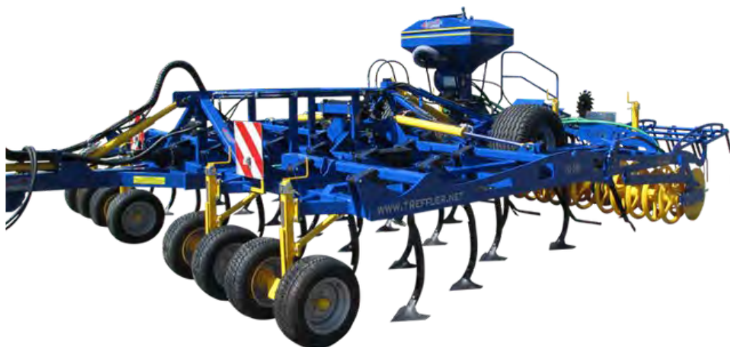
Tažený radličkový kypřič TG od firmy Treffler. Většinu radličkových kypřičů je možné osadit výsevním ústrojím pro přímé seti hlavních plodin nebo zakládání porostů meziplodin
