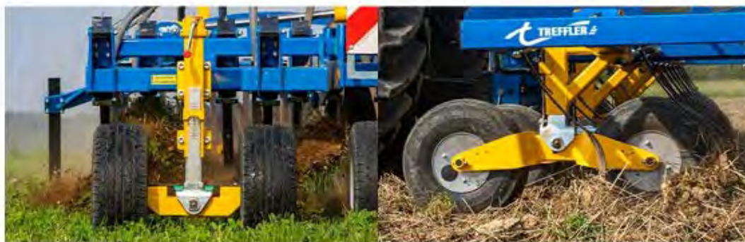
Výkyvná opěrná kola u taženého nářadí Treffler TG vlevo a neseného nářadí TGA vpravo.
